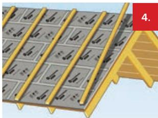
**5. Монтаж обрешетки.** Далее сверху монтируется разреженная обрешетка из деревянных досок, к которой крепится сплошной настил из плит ОСП или фанеры ФСФ. Плиты сплошного настила укладываются в разбежку с зазором 3–5 мм. Они служат основанием под гибкую черепицу.
